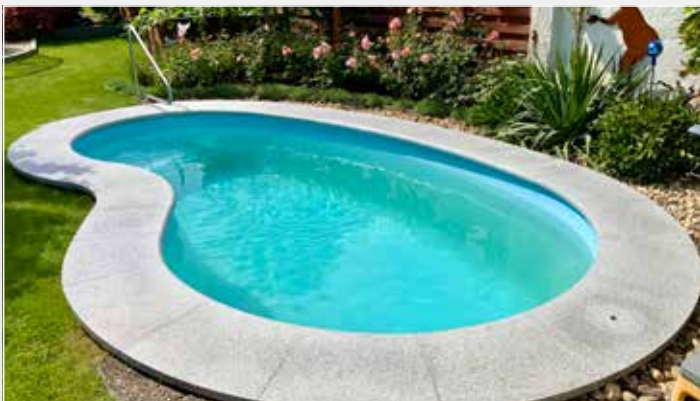
Sonderform Beckenrandsteine (Anfertigung nach Schablone)
